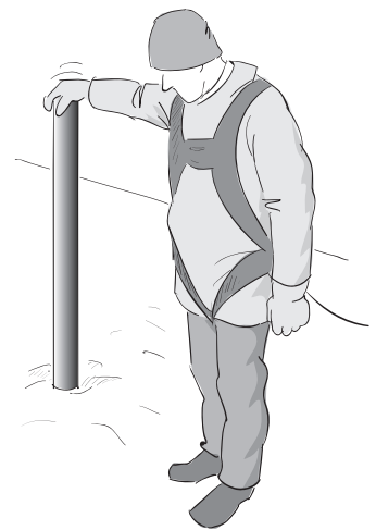
Stick ett rör genom snön tills det bottenar mot takytan.
