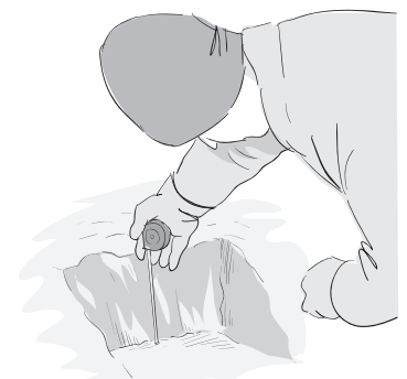
Stick in en spade under röret. Lyft upp det och väg snöinnehållet.
