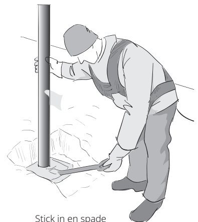
Stick in en spade under röret. Lyft upp det och väg snöinnehållet.
